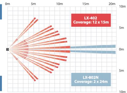
Commentaire: Attention au positionnement, il faut éviter d'avoir de la végétation en mouvement dans le champ du détecteur. S'assurer que le soleil ne tape pas directement sur la lentille du détecteur. Idéalement le détecteur doit être abrité. Fixation entre 2,5 et 3 mètres de hauteur.
