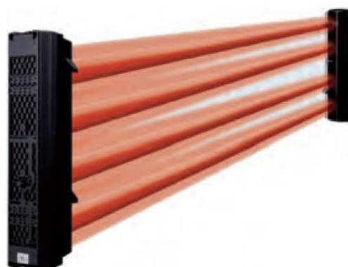
Commentaire: Chaque barrière est livrée avec sa partie émettrice et réceptrice. Peut être empilé pour la création de colonne grâce à la sélection de canaux différents. Attention à toutes les obstructions de faisceaux : végétation, véhicule, palette... Le système est constitué d'une partie émettrice d'infrarouge pulsé (comme une télécommande de télévision) et d'un récepteur. Donc pas d'obstacle entre les deux parties. Peut-être installé en plein soleil.
